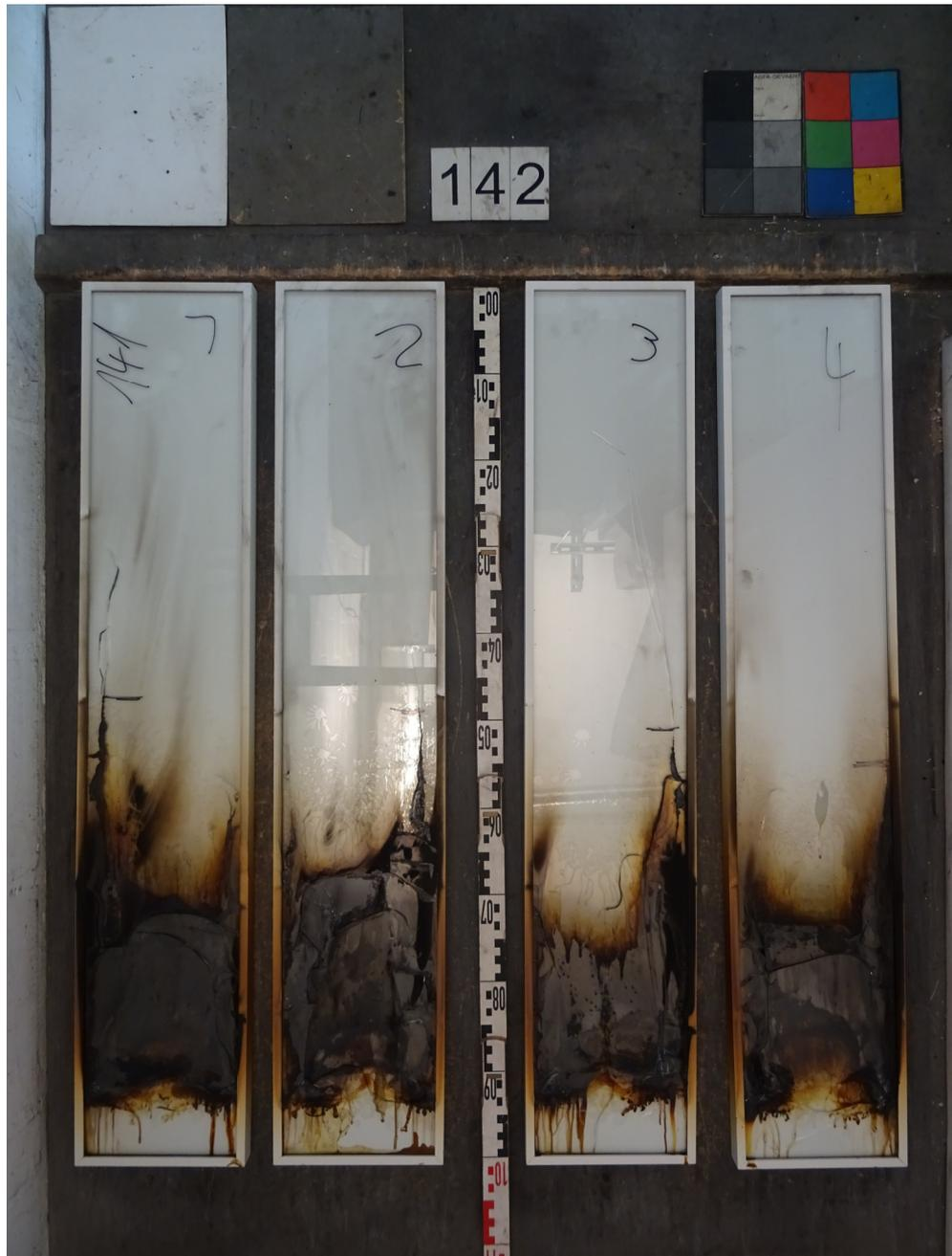
Bild 1: Aussehen des Probekörpers D nach dem Brandschachtversuch
