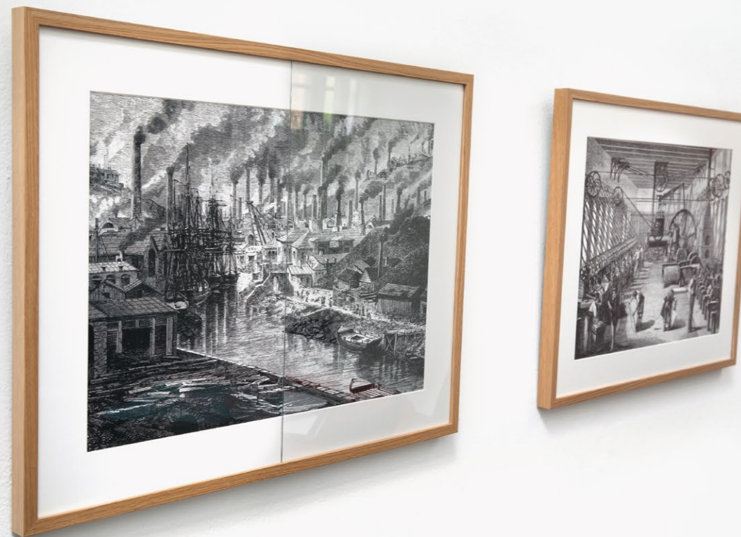
Links: Interferenzoptisch entspiegeltes Glas · Rechts: Normalglas glänzend
