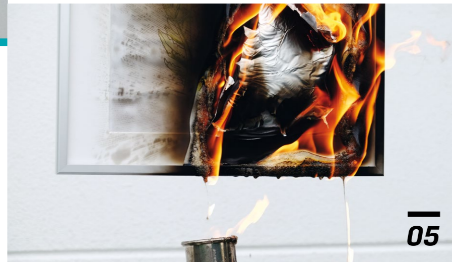
CLASSIC mit Acrylglas: Das Acrylglas fängt Feuer, tropft ab und brennt nach Entfernen der Zündquelle weiter. (Abb. 05)
