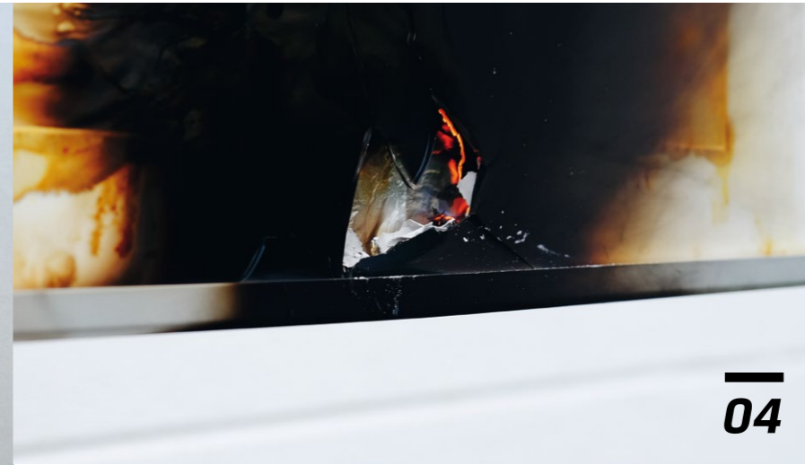
CLASSIC mit Normalglas: Die Rückwand fängt Feuer und glimmt nach Entfernen der Brandquelle nach. Die Glasscheibe kann reißen und es entstehen scharfe Scherben. (Abb. 04)
