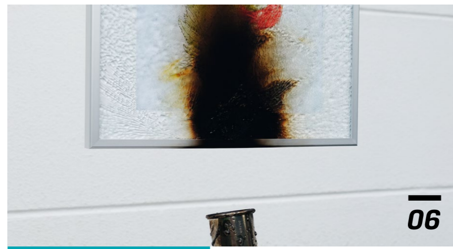
B1-Rahmen mit Einscheibensicherheitsglas: Der Rahmen fängt so gut wie kein Feuer. Die Flamme erlischt sofort nach Entfernen der Zündquelle von selbst und reduziert somit die Brandgefahr erheblich. Die Scheibe kann platzen, die stumpfen Stücken verbleiben aber im Rahmen. (Abb. 06)
